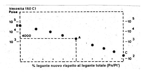
Indicando con A il punto le cui coordinate sono: il valore ottenuto di Pn/Pt ed il valore della viscosità di 4.000 poise, l'intersezione della retta con l'asse verticale corrispondente al valore 100 dell'asse orizzontale, fornisce il valore C della viscosità del legante che deve essere aggiunto.
